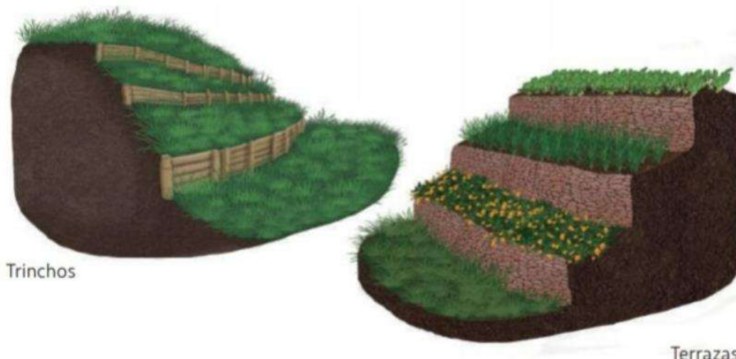
Ilustración 8 Ejemplo de implantación de obras de bioingeniería tipo estabilización viva con trinchos de guadua.
